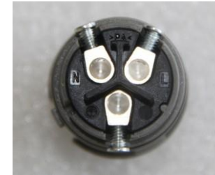
▲ Figuur 4.11 Connector AC-netaansluiting binnen
